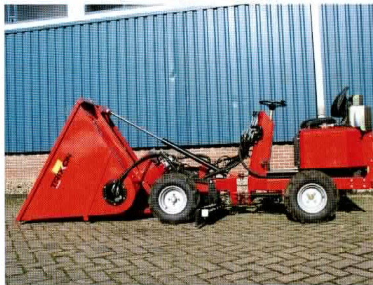
De Trixon N4500 kan zichzelf laden. Dan moet je de bezem uitklappen.
