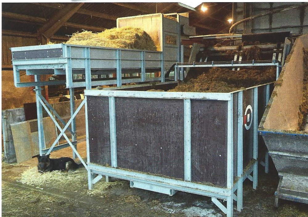
Lagerets bund er vandret. Det betyder, at man kan køre foderet ind i blokke, som bliver sående til opriveren får fat i den for enden af kassen. Dermed sker der færre skader på foderet, som derfor ikke så nemt tager varme. Foto: Torben Worsøe.
