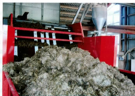
Grovfoderet føres vandret frem i magasinet og derefter lodret op til dosering i foderrobotten.
