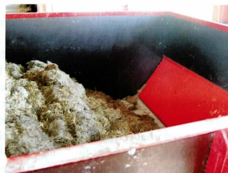
Grovfodermagasinet rummer foder til to dage, og der sker ingen sammenblanding af foderet i magasinet.
