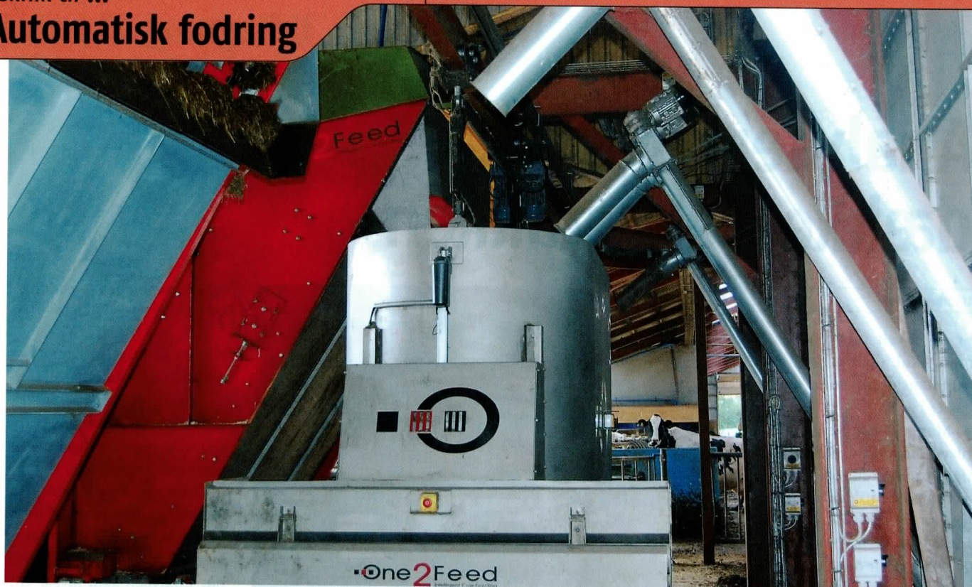
Fodervognen på vej hen for at blive fyldt fra grovfodermagasinerne. Fodervognen hænger i vejeceller, så det er dem, der afgør, hvor meget der skal læsses.
