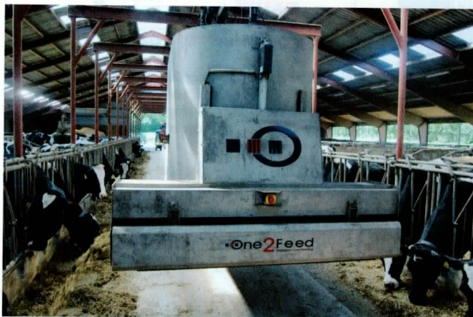
Fodervognen er skinneophængt og kan køre rundt og fodre alle dyrene, så der kun er ét fodersystem. Vognen drives af 380 V via en lukket strømskinne, så der er ingen batterier eller ladestationer.
