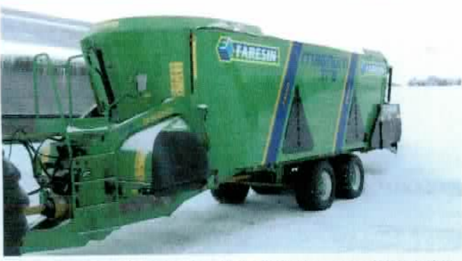
Der er en ny og forbedret opbygning af undervognen, hvor styrken fra blandekarret udnyttes til at give ekstra styrke og holdbarhed til hele vognen.
