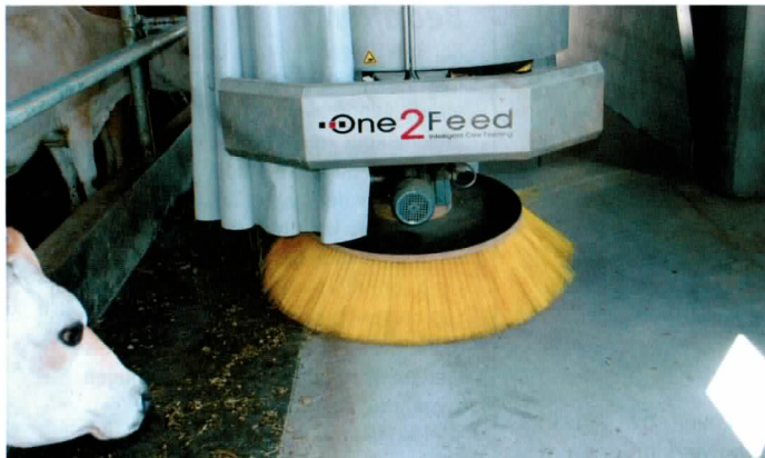
Det automatiske fodringsanlæg er det første One2Feed-anlæg i Danmark, som kører med en kost til at feje foder ind.
